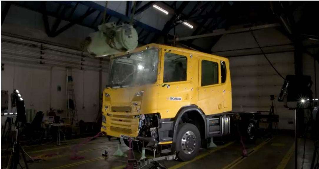
Prueba de Impacto en Travesaño Frontal acorde a VVFS 2003:29
