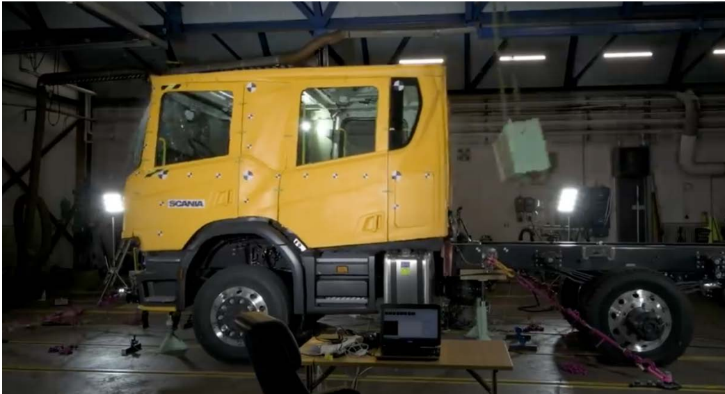
Resistencia de la pared Posterior, acorde a ECE-29R y VVFS 2003:29
