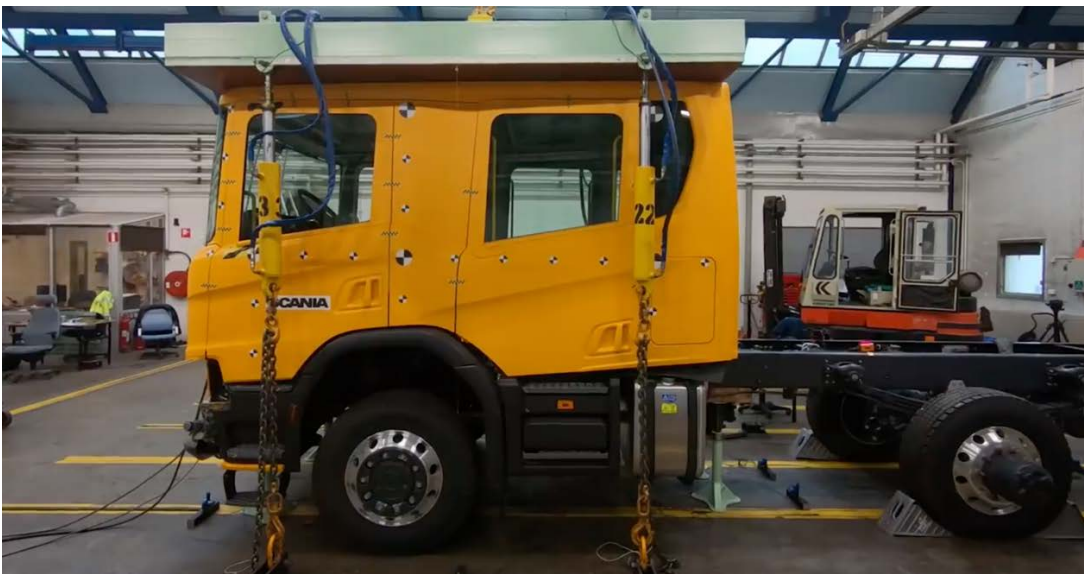
Resistencia del Techo 10 Ton. acorde a ECE-29R (15 Ton, acorde a VVFS 2003:29)
