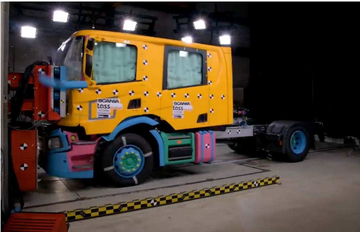
Resistencia de Impacto Frontal Acorde a ECE-29R
